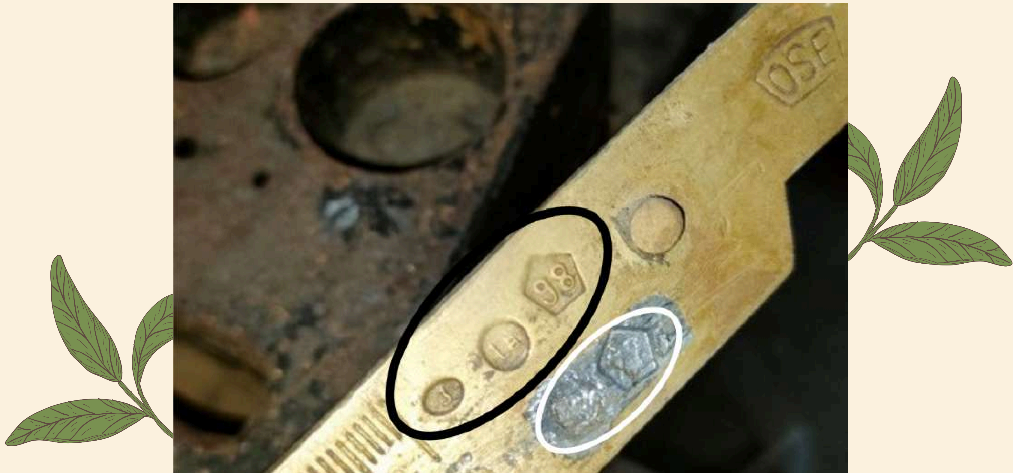
Cap Tanda Tera (CTT) pada Timbangan Sentisimal
