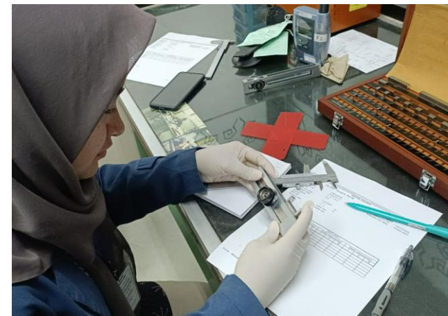
Kalibrasi Jangka Sorong di GMF Aeroasia
