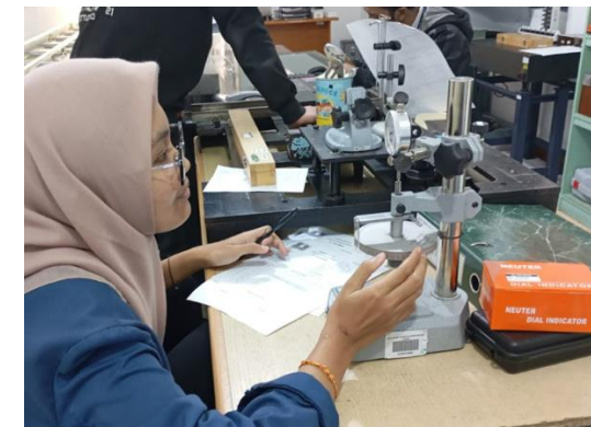
Pengujian Dial Gauge Di PT Kaliman
