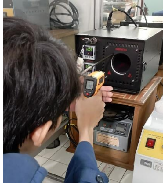
Kalibrasi Termometer Inframerah di PT Kaliman
