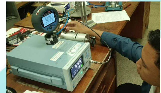
Kalibrasi Pressure Gauge di BSN
