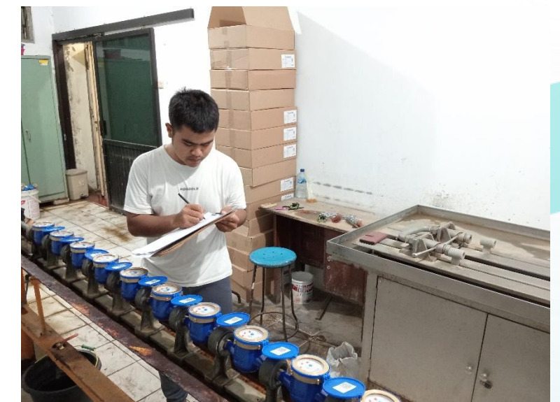
Pengujian Meter Air di UPTD Metrologi Legal Kota Pati
