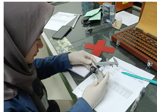
Kalibrasi Jangka Sorong di GMF Aeroasia
